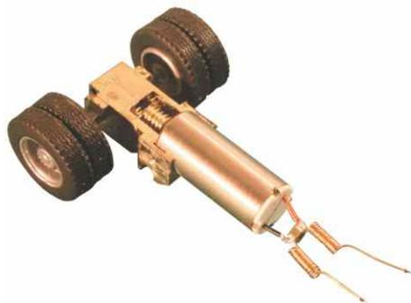
Bei der vollständigen Motorentstörung werden die Störspitzen nicht nur durch Kondensatoren kurzgeschlossen, sondern auch die noch verbleibenden Störfrequenzen Richtung Fahrregler blockiert. Dies geschieht durch Spulen.
