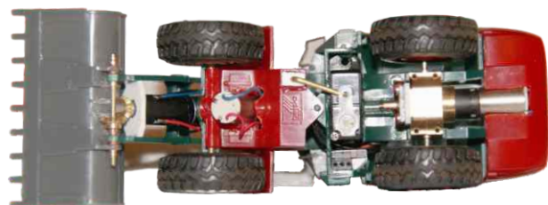
Getriebebausatz G494, in einem 1zu87 Radlader eingebaut
