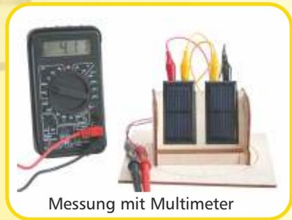
Werden Solarzellen in Reihe geschaltet, erhöht sich die Gesamtspannung.
