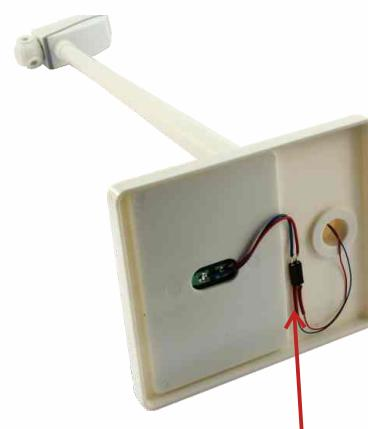
(DT) Verbinden Sie nun den Stecker des Mastes mit der Unterseite der Bodenplatte. Blaues Kabel zu blauem Kabel, rotes Kabel zu rotem Kabel.
