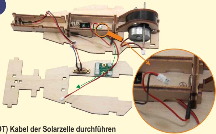
(DT) Kabel der Solarzelle durchführen
