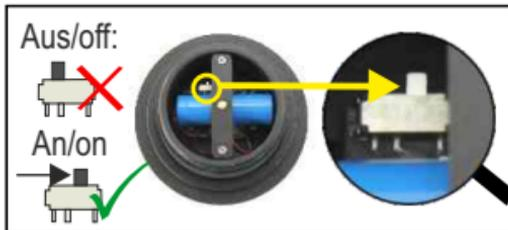
3 Nun ist die Lampe aktiviert. Verschließen Sie die Solareinheit wieder. Achten Sie dabei darauf, dass beide Dichtungen sauber aufliegen und verschrauben Sie nun drehend und mit etwas Druck beide Gehäuseteile miteinander. Die Dichtungen werden somit angepresst und sorgen für eine hohe Gehäusedichtheit, welche für einen langen Gebrauch des Produktes steht.
