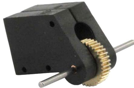
Zahnrad nun von Hand andrehen. Wenn das Zahnrad weiterdreht, ist alles OK. Bremsst das Zahnrad sofort wieder ab: Zahnrad und Achse erneut von überflüssigen Kleber befreien.
